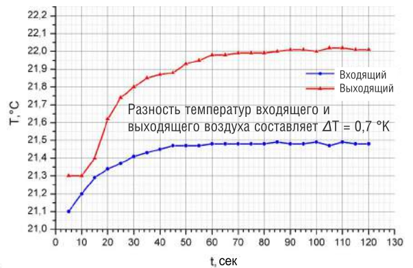
График: Регистрация температуры воздушных потоков
