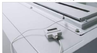
Измерение температуры выходящего воздушного потока
